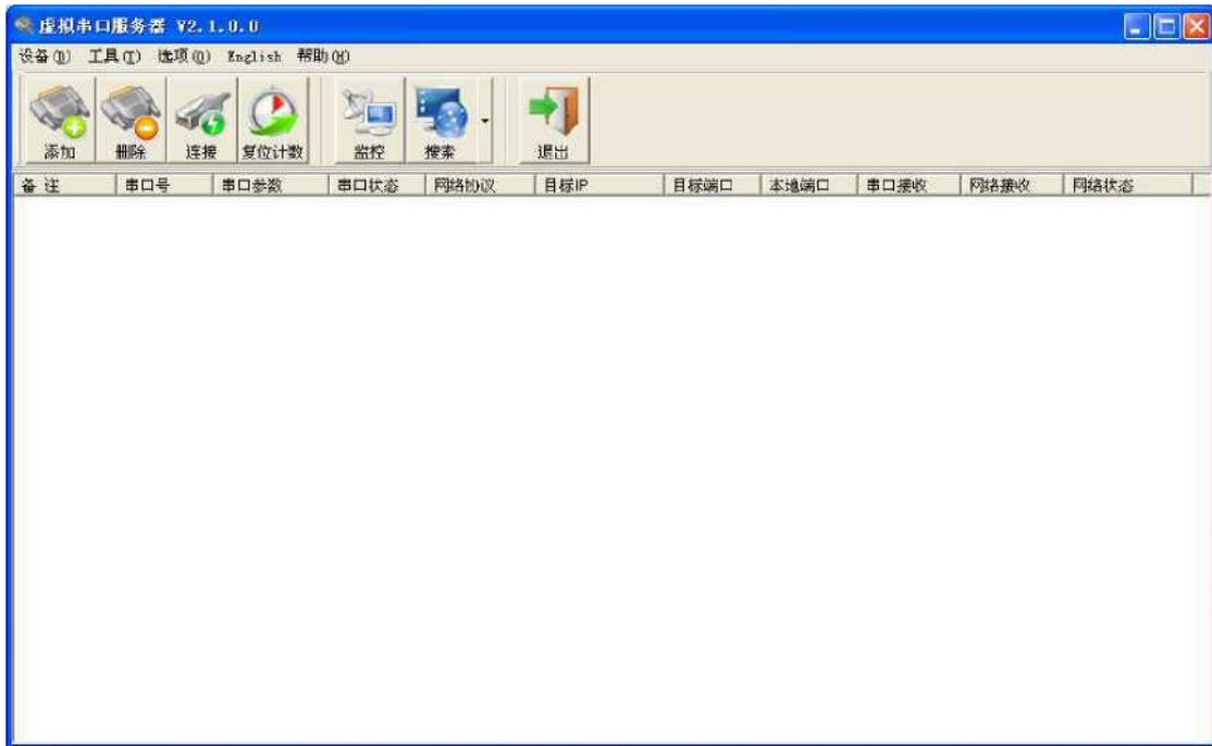
添加虚拟串口，将生成的 COM 端口号，计算机工作于 TCP Server 模式，计算机的 IP;计算机的端口，点 击确认，即可创建 COM2 口，COM2 口收到的数据就是来自 TCP 设备反过来的数据，向 COM2 口发送数据就会通过 TCP 传输到网络远端的
