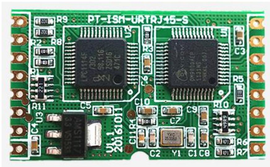
功能完全兼容插针式模块，适用于小体积需求及用户自由布局需求，外界网络变压器及RJ45 插座或者带网络变压器的 RJ45 插座即可。
