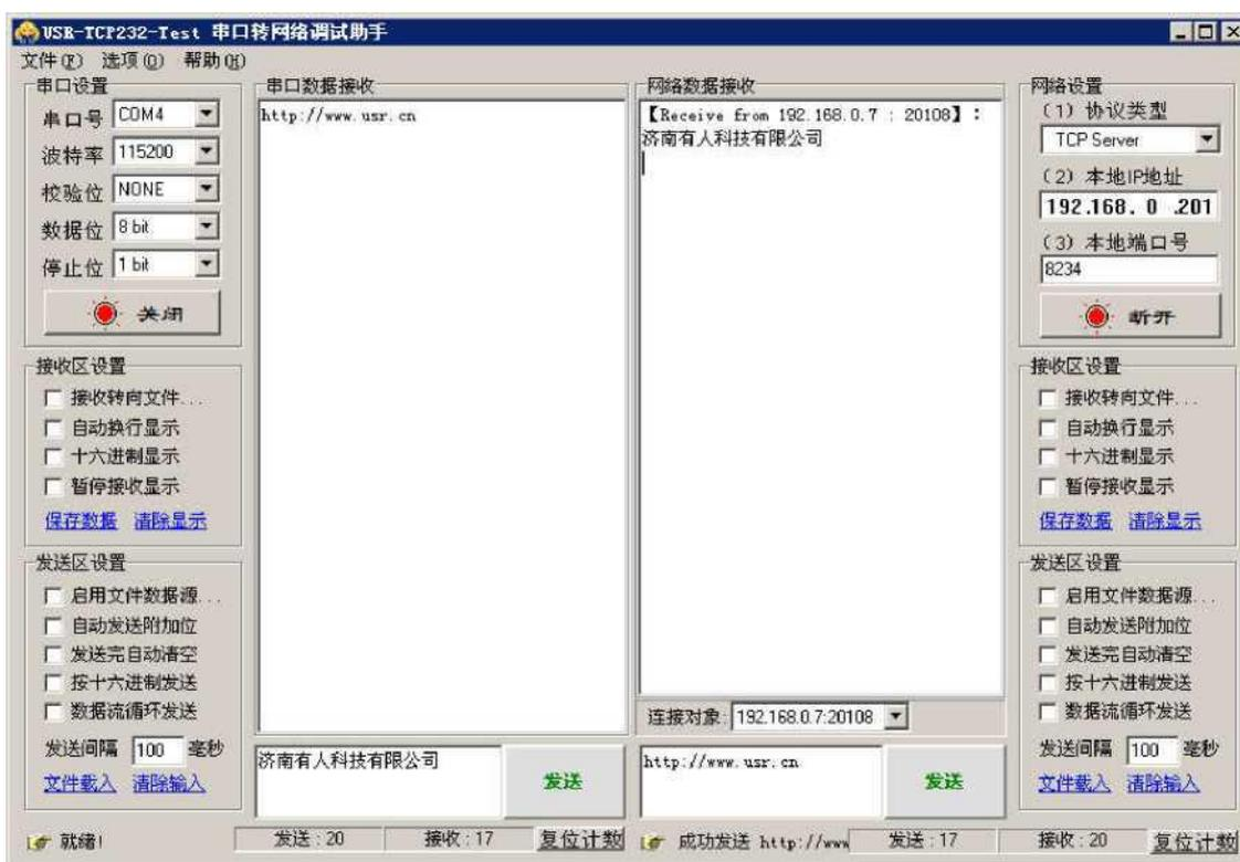
1、打开串口以收发数据，设置波特率为 115200，并且设置正确的端口，打开串口。
