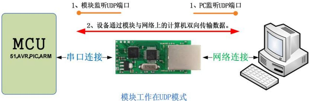
Test 助手，双向收发测试，模块工作在 UDP 模式下。
